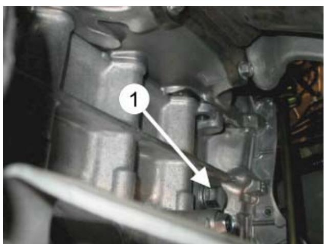
**N** Demonter plastplaten under motor. Demonter den originale gjengepluggen (1) og monter varmeren (2). Benytt evt. en oppsplittet lang hylse ved tiltrekking av varmeren. Päfyll godkjent kjølevæske, og luft systemet ifølge bilprodusentens spesifikasjoner. Kontroller for lekkasje.
