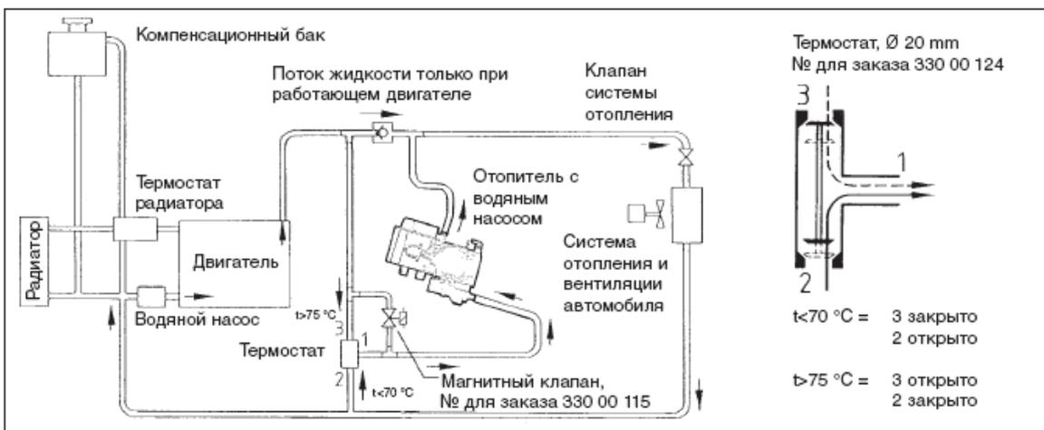
**Подключение с переключающим электромагнитным клапаном.**
