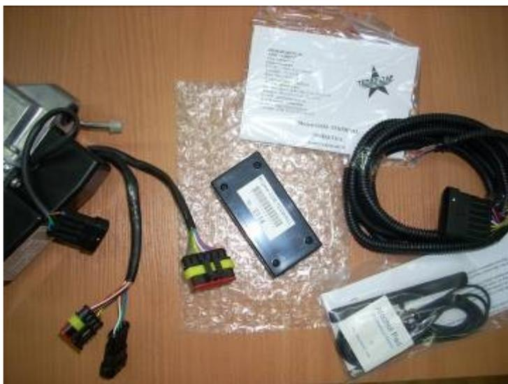
Подключаем кабель (из комплектации модема) с 6 (шести) контактным разъёмом к соответствующему разъёму БИНАРА 5.
