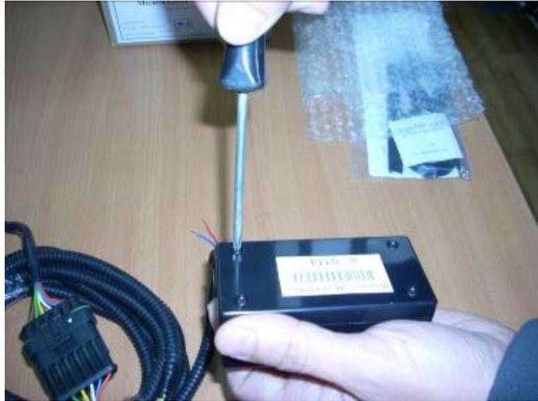
и снимаем крышку, на внутренней стороне которой наклеена этикетка на которой подробно написано соответствие цвета подключаемого провода и контактной клеммы.
