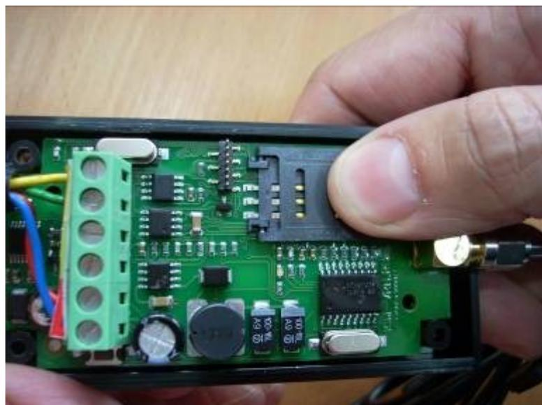
На противоположном конце платы находится гнездо для подключения антенны, к нему прикручиваем кабель с антенной входящий в комплект модема.
