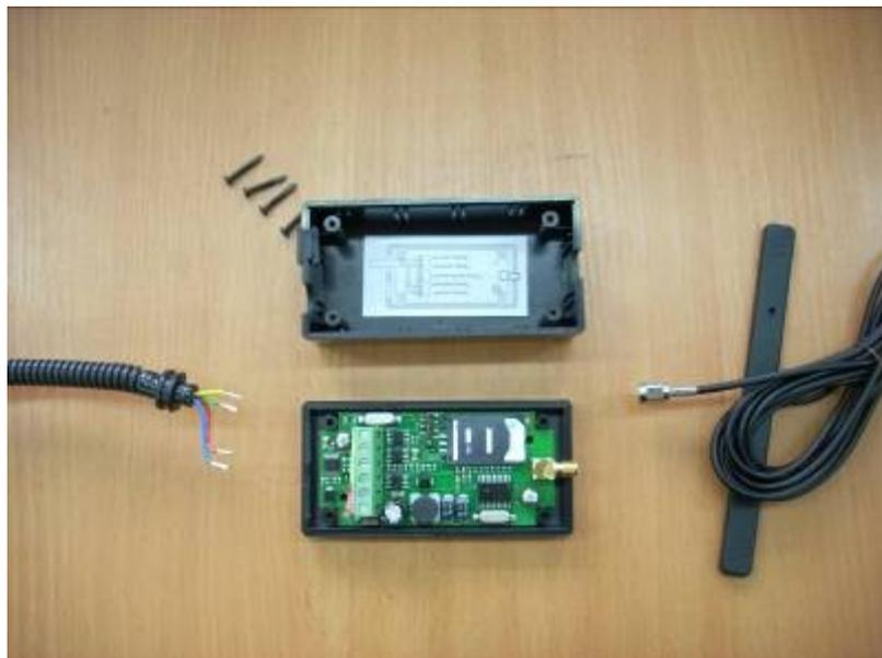
Плоской отвёрткой затягиваем провода в контактной колодке.
