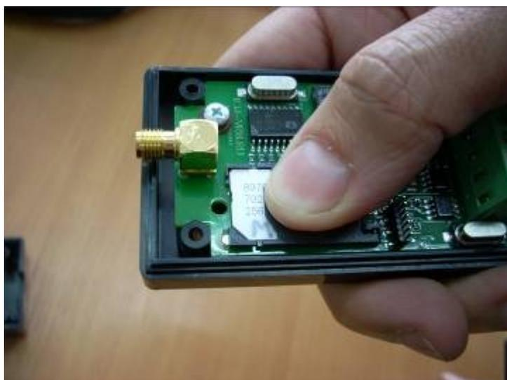
ВНИМАНИЕ ! У SIM карты должен быть отключен запрос PIN кода, и в телефонной книге записан хотя бы один телефонный номер (подробности в инструкции).
