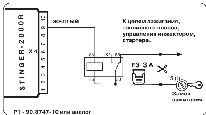
Рис.3 Схема блокировки работы двигателя разрывом цепей питания
