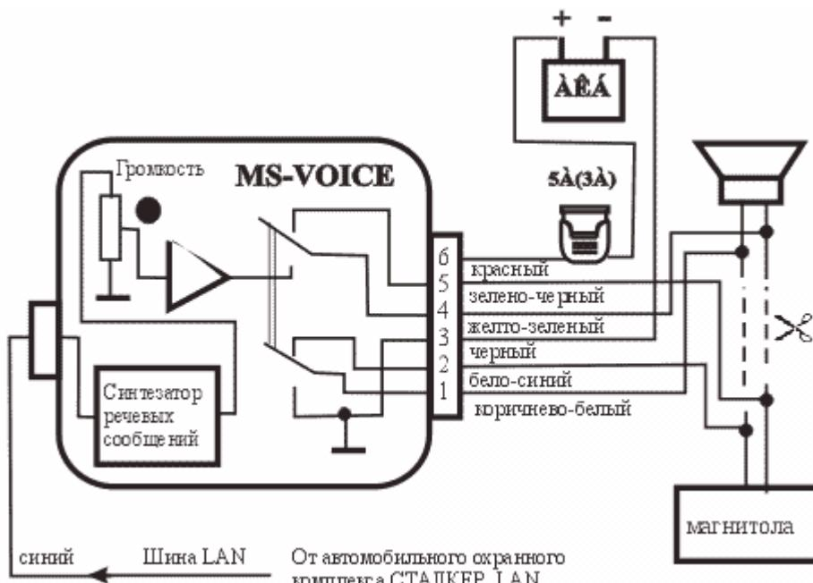
комплекса СТАЛКЕР-LAN и позволяет производить вывод речевых сообщений на колонку автомагнитолы.
