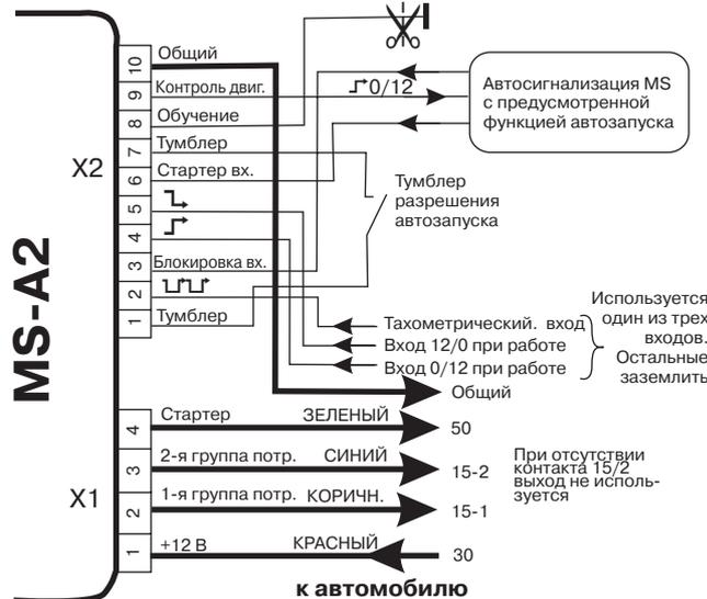
На тахометрический вход X2/2 L L L при работающем двигателе должны поступать импульсы - например, от системы зажигания, от тахометра, генератора переменного тока и т.д. Амплитуда импульсов - не более 300В, минимальная частота 4Гц.
