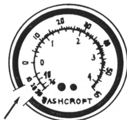
Типичный диапазон вакуума 15-25 дюймов ртутного столба
