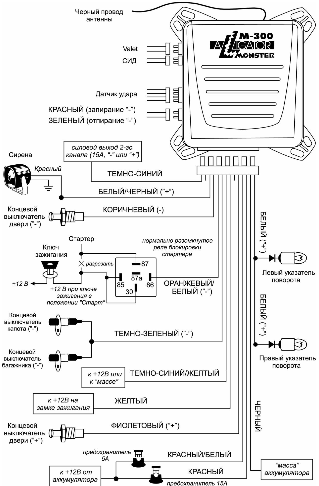
Схема 1. 3-проводная система отрицательной полярности (большинство автомобилей японского производства)
