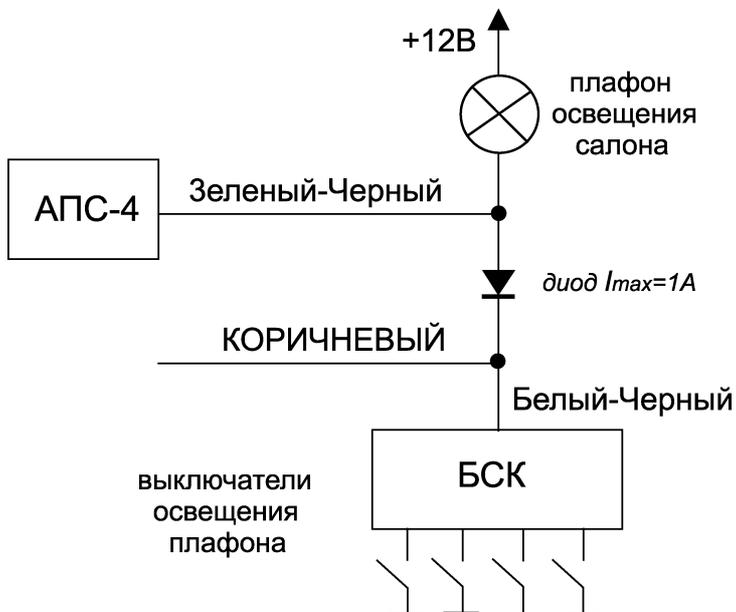
3. Рекомендуемая схема подключения ТЕМНО-ЗЕЛЕННОГО провода системы (“отрицательный триггер капота/багажника”) к подкапотной лампе автомобилей ВА3 семейств 2109, 2115, 2123 или лампе освещения багажника автомобилей ВА3 семейства 2115:
