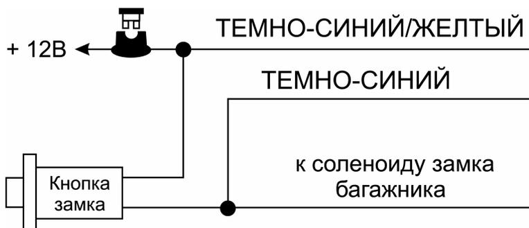
**Подсоединение:** Для дистанционного отпирания замка багажника подсоедините ТЕМНО-СИНИЙ провод и ТЕМНО-СИНИЙ/ЖЕЛТЫЙ провод системы как показано на схеме.
