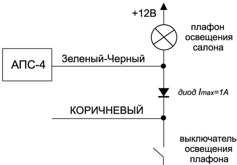
2. Рекомендуемая схема подключения КОРИЧНЕВОГО провода системы (“отрицательный триггер двери”) к проводке автомобилей ВА3 семейств 2110 и 2115, оснащенных иммобилайзерами АПС-4:
