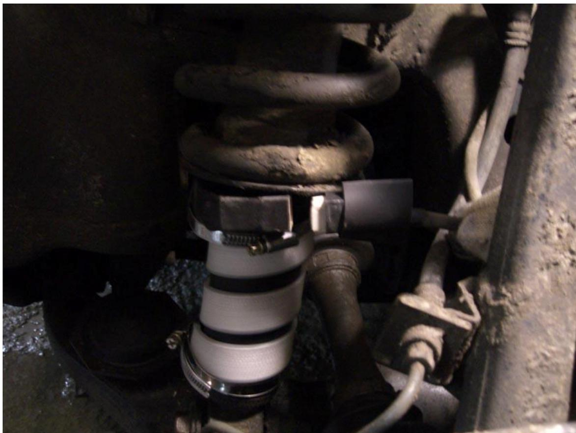
*Нагрейте термоусадку, проверьте прочность соединения.*
