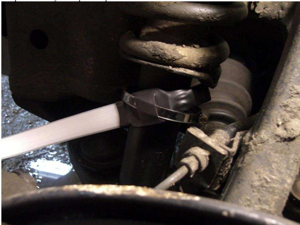
*Оберните нагреватель вокруг стойки, закрепите хомутом.*
