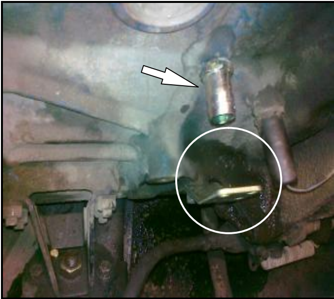
Рис.1 Монтаж кронштейна и штуцера К1/8
