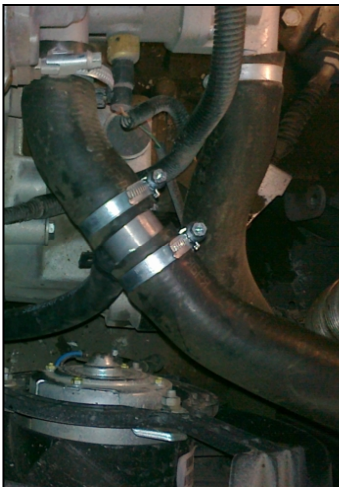
Рис.3 Положение выходного рукава и монтаж тройника 33x33x16
