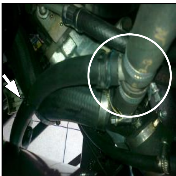
Рис.3 Монтаж тройника 19x16 и способ фиксации входного рукава
