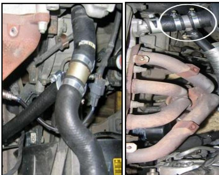
Рис. 2 подача нагретой ОЖ (слева 5А, справа 7А)
