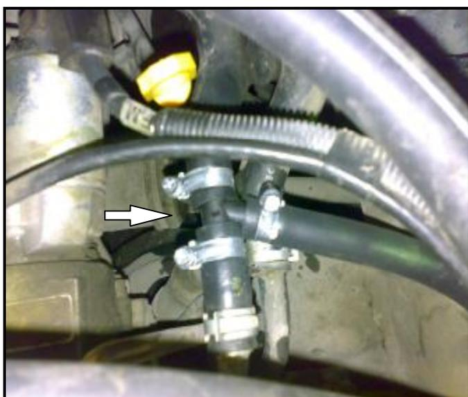
**Рис.3 Монтаж тройника 16x16 (выходной)**
