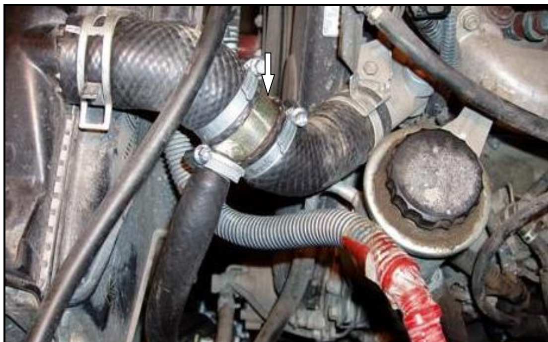
Рис. 3 Выходной рукав и врезка тройника 39x16
