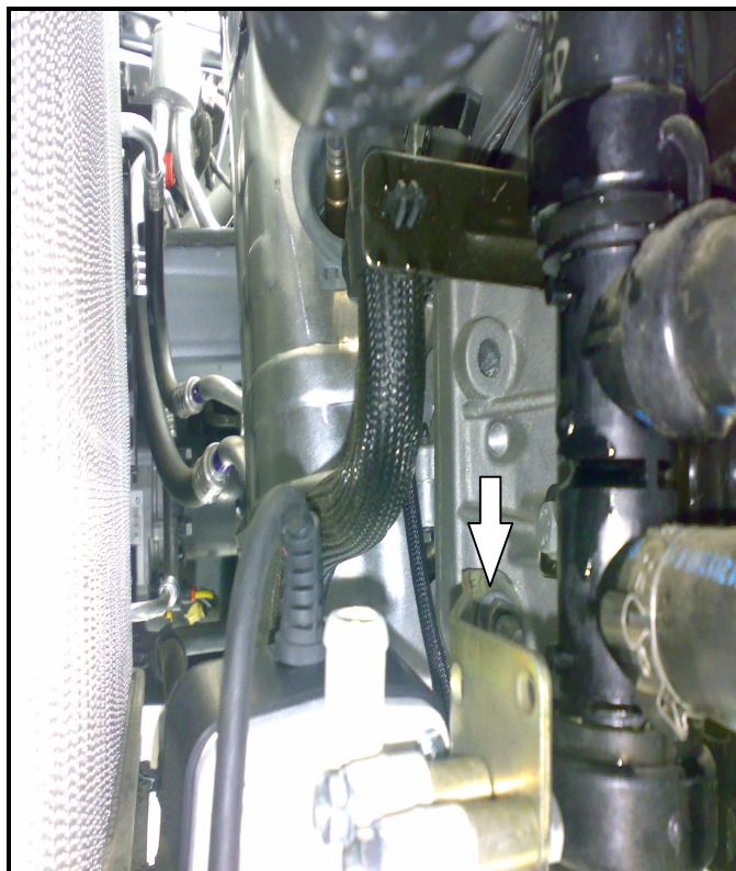
Рис. 1 Положение подогревателя и шпилька крепления
