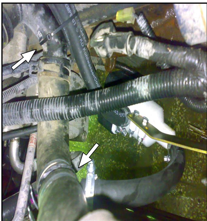
Рис.3 Монтаж тройника 35x35x16 и фиксация выходного рукава
