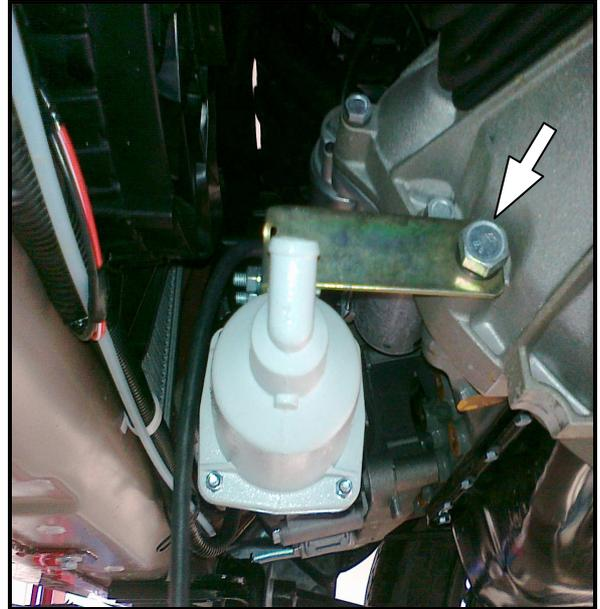
Рис.2 Монтаж подогревателя и болт крепления (вид снизу)
