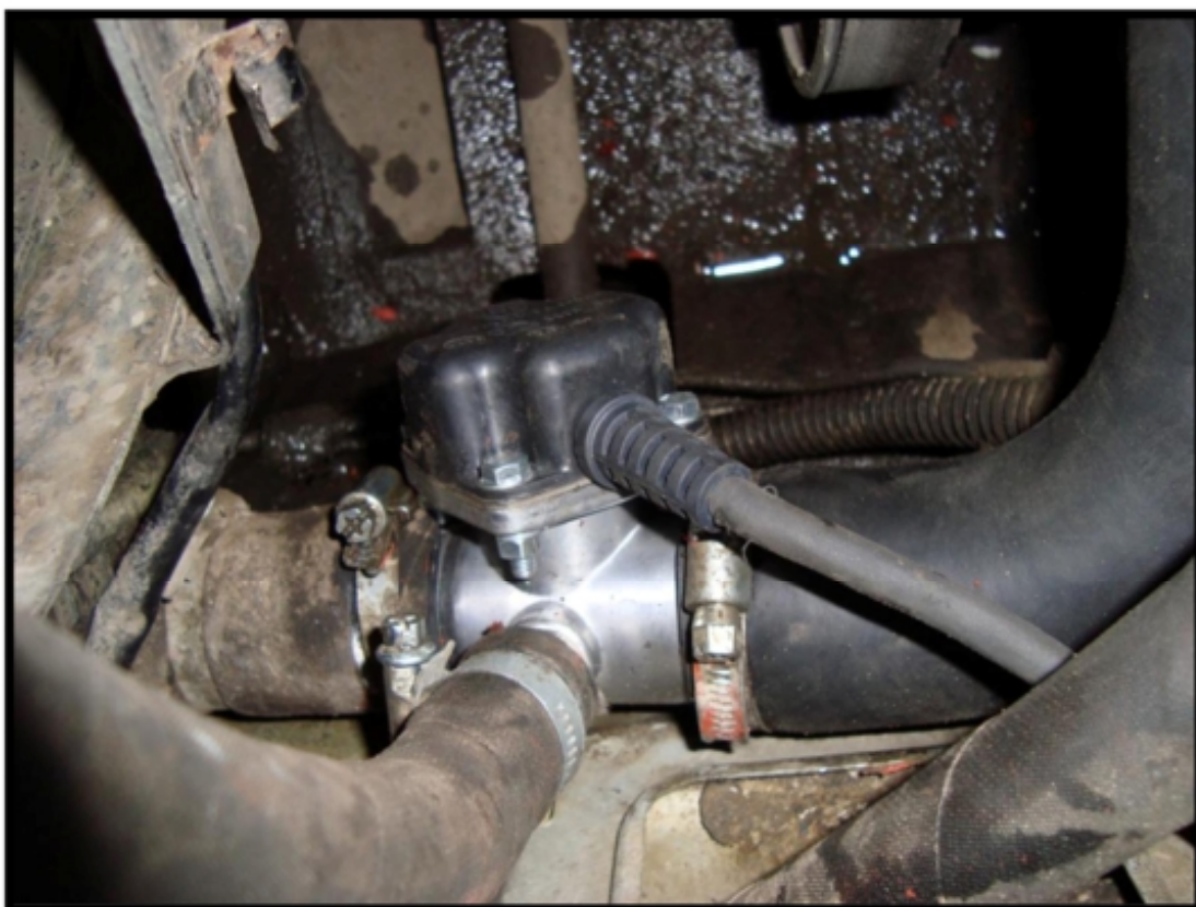
Рис.4 Монтаж подогревателя на автомобилях марки ГАЗ - 3110 «Волга».
