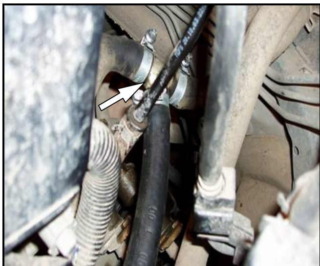
Рис.1. Место забора ОЖ двигатель TOYOTA 1NZ.
