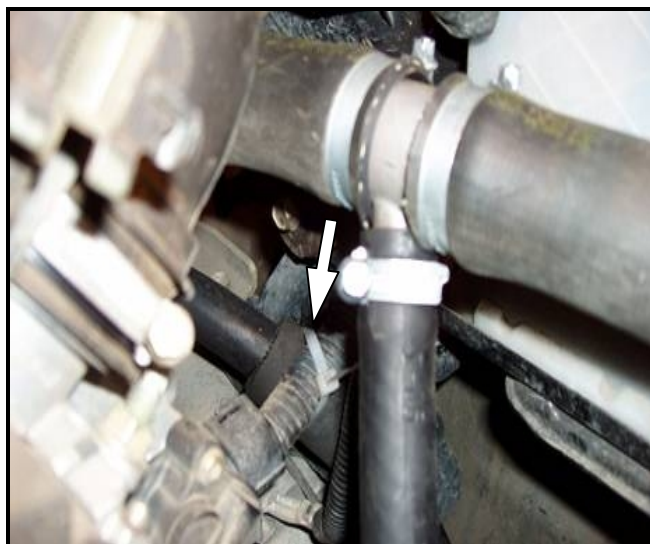
Рис.2. Подача нагретой ОЖ и фиксация входного рукава (показано стрелкой).
