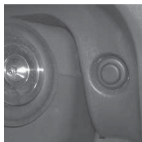
Кнопка выключателя стартера
