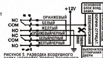
РИСУНОК 5. РАЗВОДКА ВОЗДУШНОГО ЗАМКА (ОТКРОЙТЕ КОРПУС ОСНОВНОГО БЛОКА И УСТАНОВИТЕ ВОЗДУШНЫЙ ЗАМОК)
