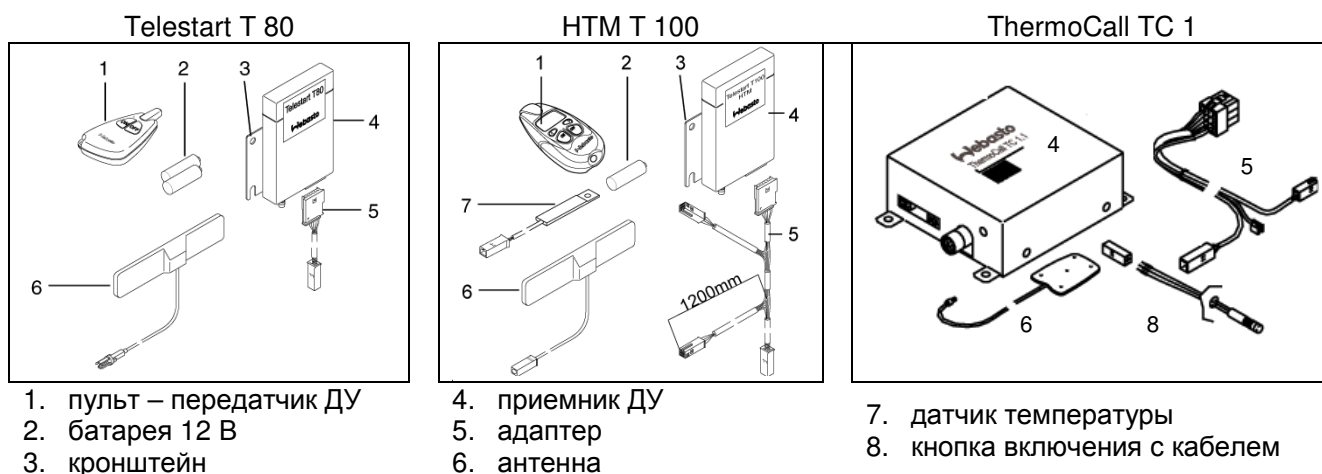
Рис. 26 Установочные комплекты систем ДУ предпусковых подогревателей Thermo Top
