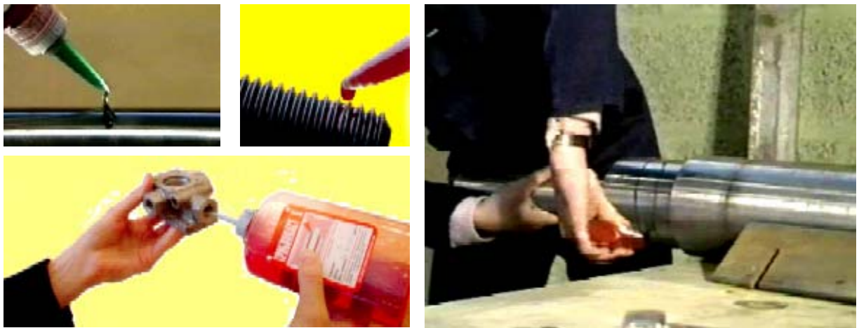
Рис.6. Нанесение герметика из флакона
