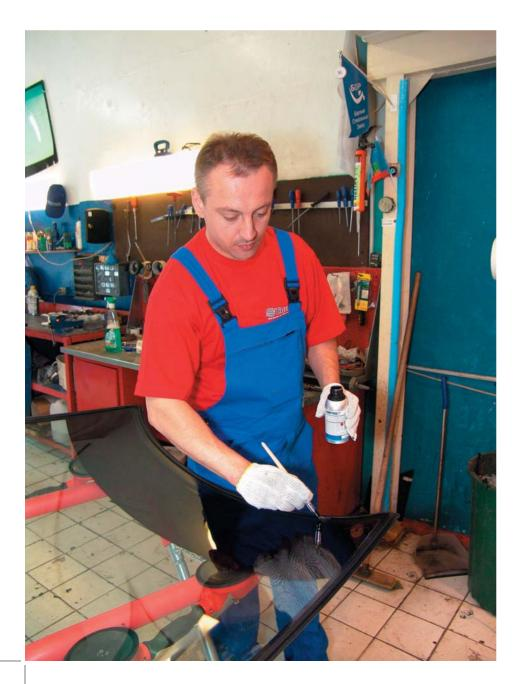
старый полиуретановый слой до толщины 1-2 мм., очищаем кузовную рамку от пыли, грязи и влаги. Места «задиров» до голого металла обрабатываются праймером Dinitrol 530 (специальный праймер черного цвета для подготовки склеиваемых поверхностей), который сохнет в течение 10 минут.
