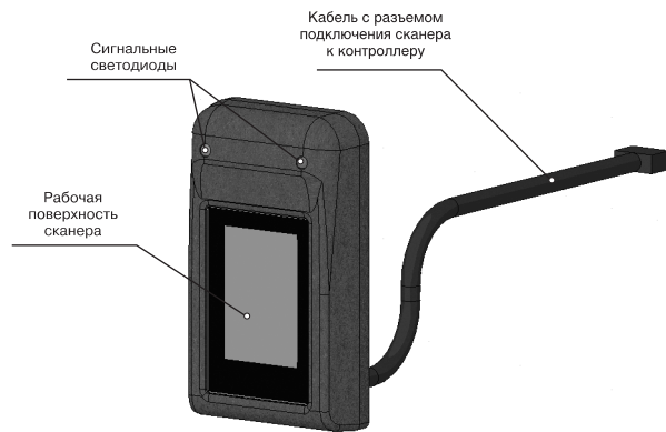
Рис.2 Сканер отпечатков пальца. Вид спереди.
