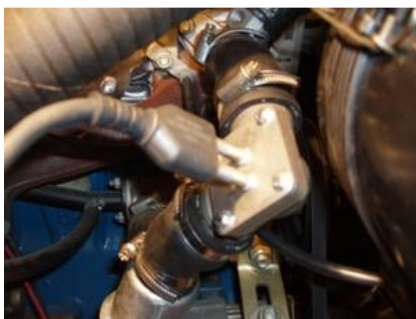
Рисунок 8 Монтаж подогревателя на ИЖ-2126-030
