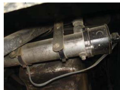
Установка подогревателя охлаждающей жидкости на КРАЗ 260
