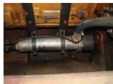
Установка подогревателя охлаждающей жидкости на трактор ЧТЗ Т-170
